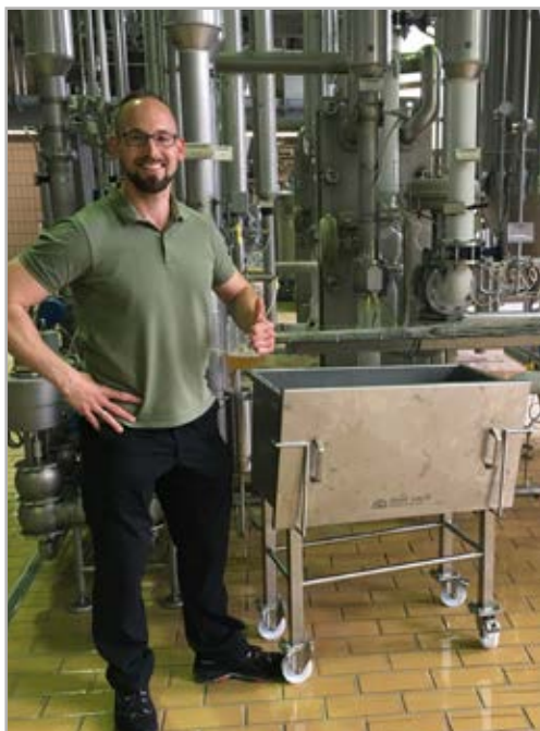
Edelstahlwanne 120 l mit passendem Deckel / ca. 2,5° Gefälle über das Gestell / seitliche Halterungen und Anschläge zum sicheren Ablegen des Deckels. Darüber freut sich Braumeister Timo Seemayer.
