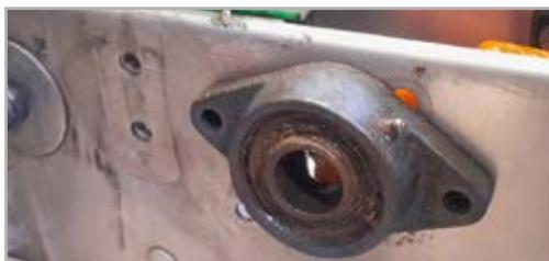
Vorher: Die alte, rostige und poröse Kugellagereinheit an den Flaschentransportbändern der Füllerei.
