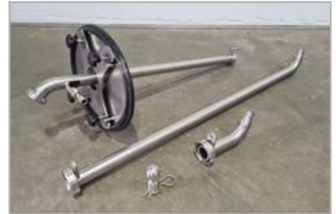
Linkes Bild: Der rotierende Sprühkopf. Rechtes Bild: Modularer Aufbau der Reinigungslanze.
