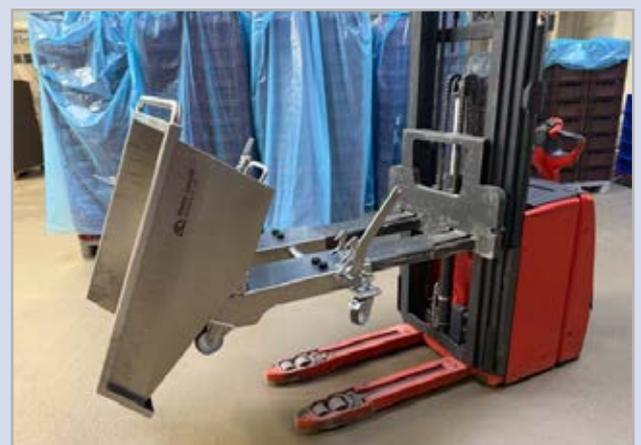
Der Muldenkipper kann dank Staplerschuhen mit dem Hochhubwagen einfach bewegt und entleert werden.
