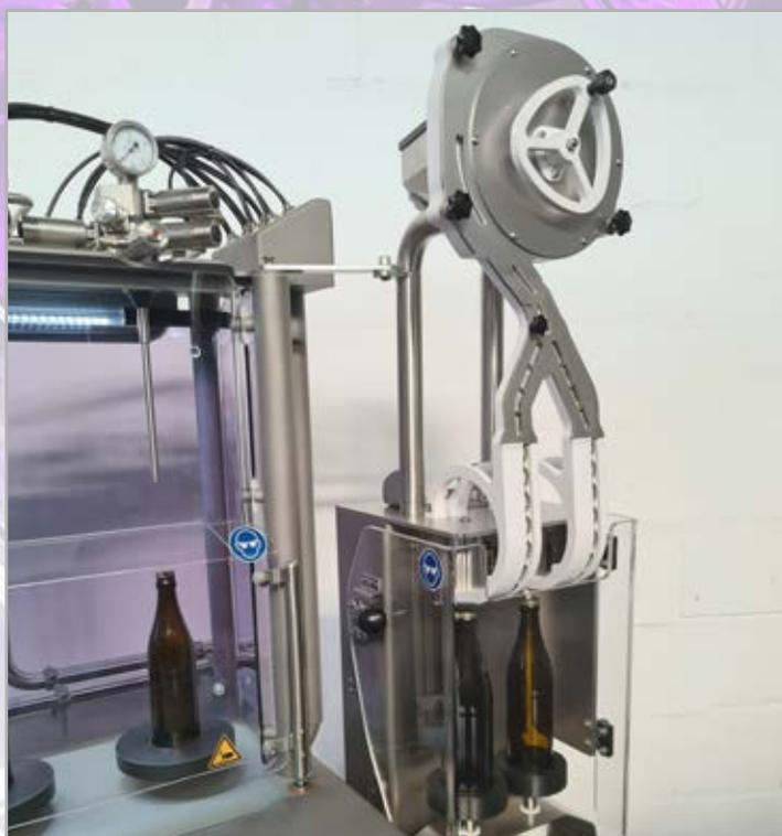
Der 2-stellige Kronenkork-Verschleißer HELBA KK2S mit Sortiertrommel und Fallkanal korkt in Sekunden über das Schließen der Drehtür.
