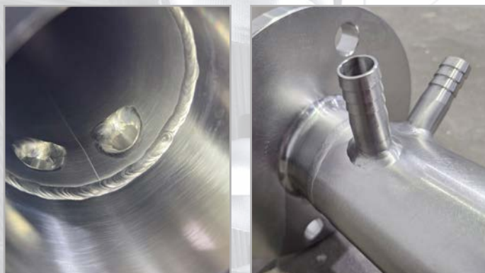
Links: Schweißnähte innen in höchster Ausführungsqualität (Wurzel); Rechts: Dieselben Schweißnähte von außen.
