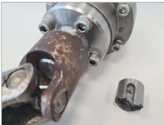
Die Reparatur einer Antriebseinheit.
