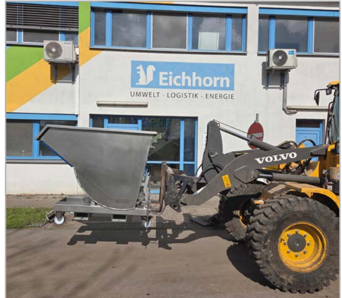
Der Muldenkipper am Radlader während der Unterweisung der Mitarbeitenden.
