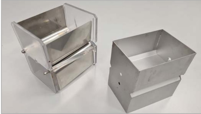
Vorher-Nachher-Dosierbecher (links alt, rechts neu).
